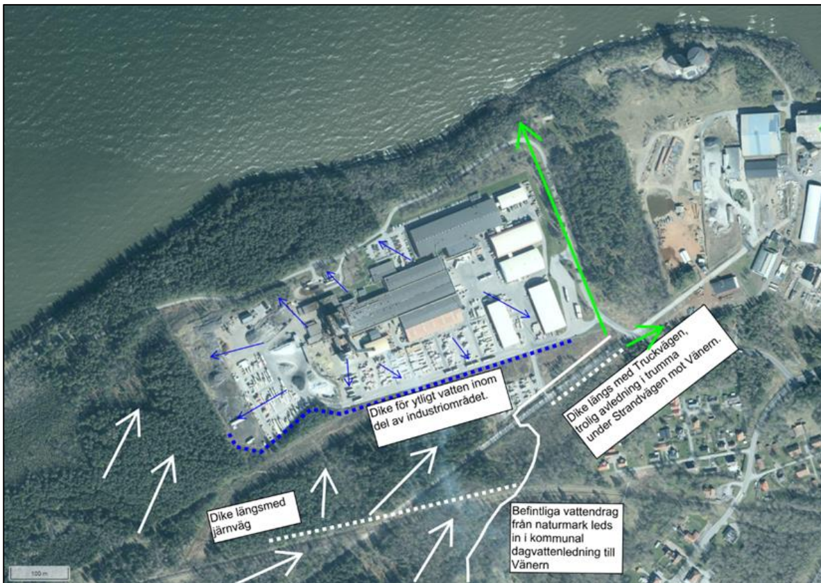
Figur 5-23 Skissade diken samt ungefärlig sträckning av befintliga allmänna VA-ledningar. Dike markerat med blått avleder yligt avrinnande vatten främst från industriområdet och dike markerat med vitt avleder yligt avrinnande vatten från naturmarken. Vit heldragen linje visar ungefärlig sträckning av vattendrag. Gröna pilar är schematiskt inritade allmänna dagvattenledningar (Sweco, 2021b).
