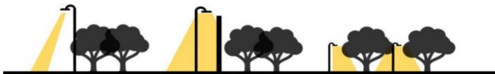
Figur 5-11 Lampor som kan riktas och bara lysa upp det som är avsett (exempelvis vägbanan) minskar mängden onödigt ljus. Samma effekt kan uppnås genom avskärmning eller genom att låta lampor placeras på lägre höjd.
