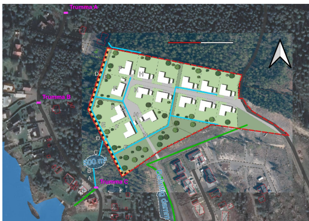
Figur 9: översikt över föreslagen dagvattenlösning med ett västlig magasinläge och med beteckningar för höjdnivåer (A – H) som ansluter till tabell 3.
