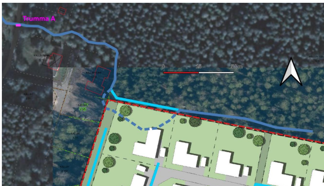
Figur 8: förslaget till omledning av bäckfåran, norr om planområdets gräns visas med turkos linje. Ursprunglig sträckning (delvis streckad) visas med mörkare blå linje, efter Lantmäteriets terrängkarta.
