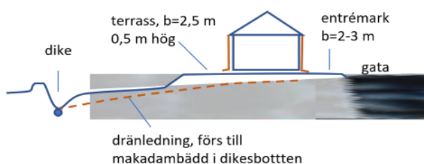
Figur 7: ett förslag på uppsamling av dagvatten med små diken/ledning visasschematiskt med ljusblå linjer utifrån erhållen situationsplan. Grön linje visar ungefärligt läge för befintlig dagvattenledning och dike för den redan färdigställda etapp 3. Nedanför kartan finns en schematisk bild på dagvattenavledning för tomter som behöver fyllas upp i planområdets västra del, respektive tomter där urschaktning utförs.
