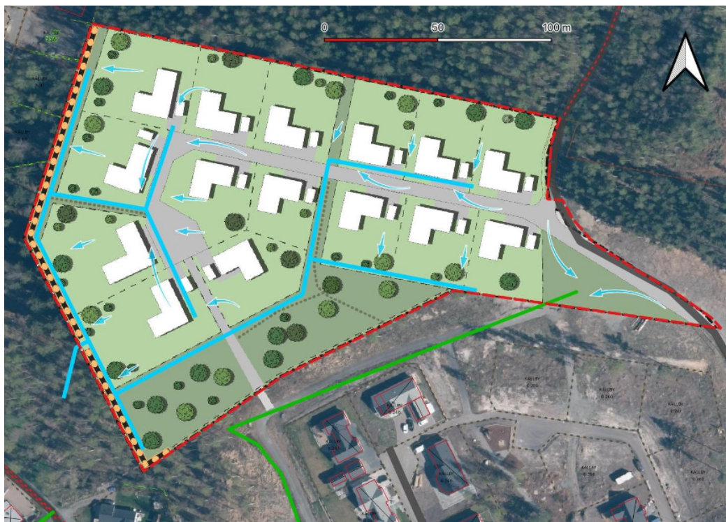
Dagvattenavledning, vid uppfyllnad
