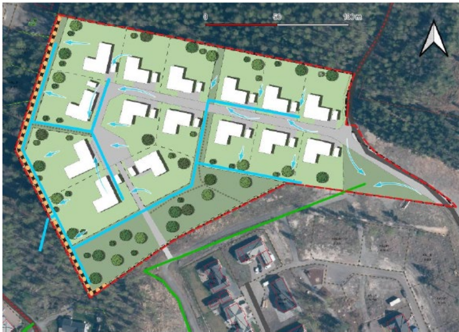
Dagvattenavledning, vid uppfyllnad
