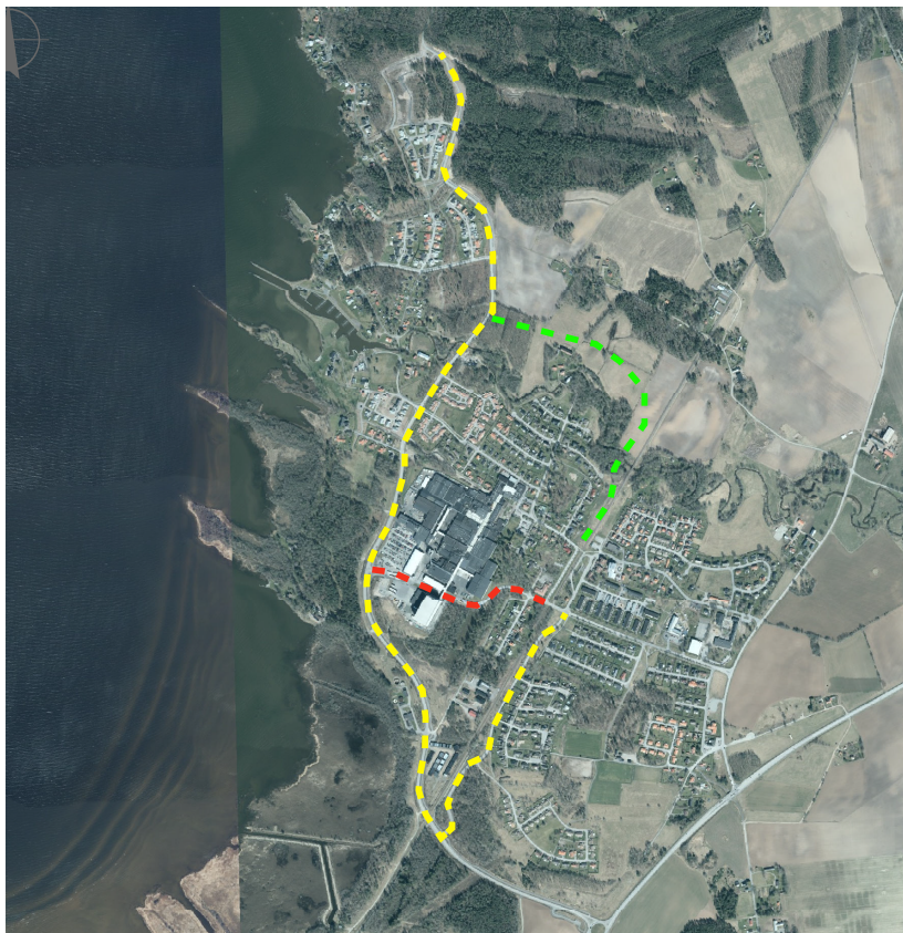
Figur 1. Röd linje visar den genomfartsväg som idag är stängd. Gul linje visar dagens gatuförbindelse mellan de nordvästra och de centrala delarna av samhället. Grön linje visar ungefärlig sträckning av ny väg.
