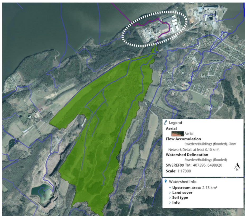
Figur 13 Avrinningsområde av omkringliggande mark som enligt Scalgo Live påverkar befintligt industriområde.
