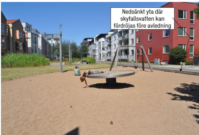
Figur 5-16 Multifunktionell yta där höjdsättning av ytor och utflödespunkter genererar fördröjningsvolym för skyfallshändelser.
