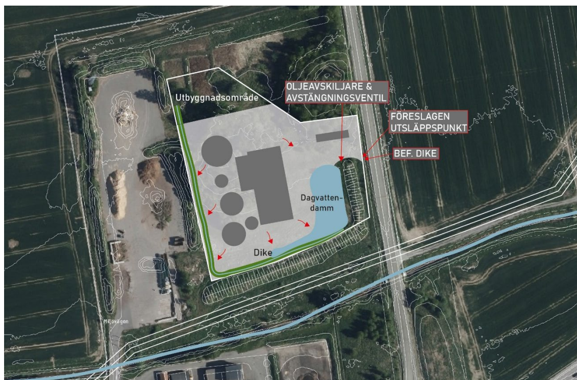
Figur 10, Dagvattenhanteringen redovisas på principiell nivå och anger huvudprinciper för fördröjning och viss rening inom planområdet. Exakt utformning, dimensionering och placering av dagvattenanläggningar fastställs i senare skeden
