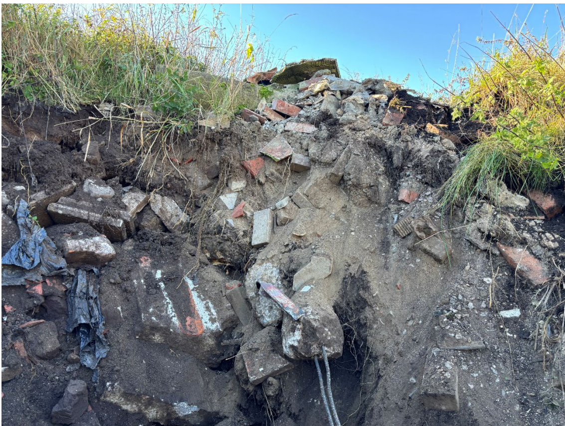
Foto 6.1. Visar exempel på tydlig förekomst av byggrester/avfall i jordvallen, som återfinns i den södra delen av undersökningsområdet, sektion A3.
