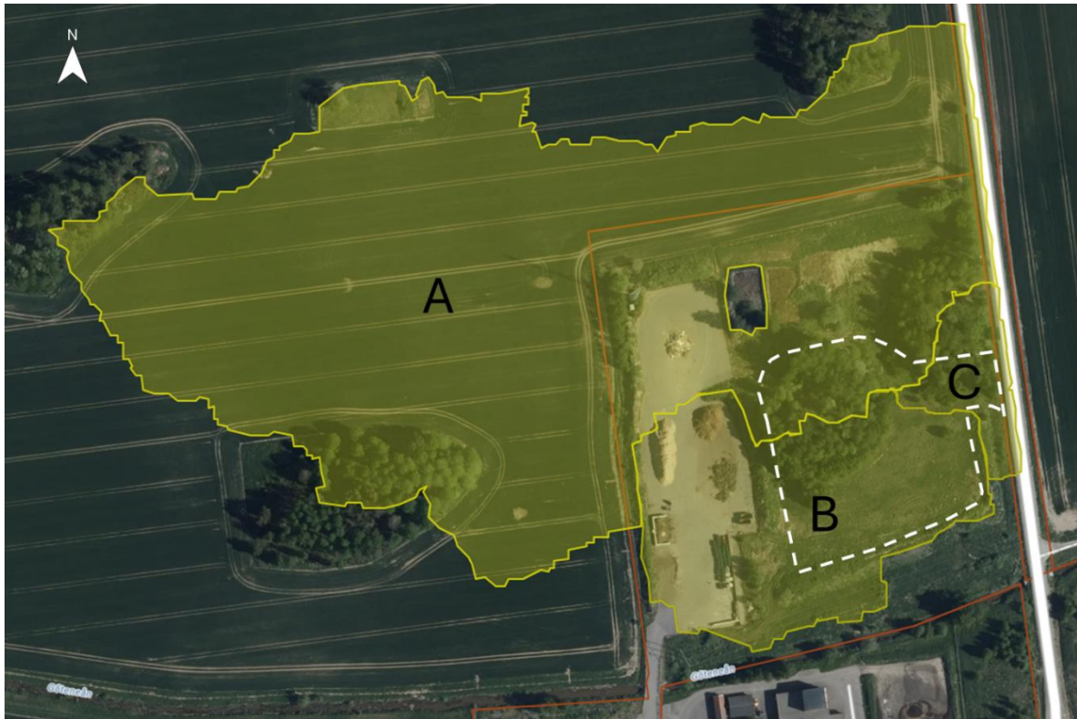
Figur 6. Utredningsområdet ligger inom tre olika avrinningsområden. Avrinningsområdena markeras med gul skraffering och har identifierats i Scalgo Live. Vit streckad linje markerar utredningsområdet vid fastigheten Sils-Sandtorp 1:15.
