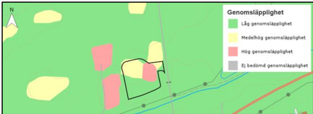
Figur 12: Genomsläpplighet för jordarter i utredningsområdet. Utredningsområdet har markerats med svart rektangel. Karta hämtad från © SGU5 Kartvisare Genomsläpplighet.
