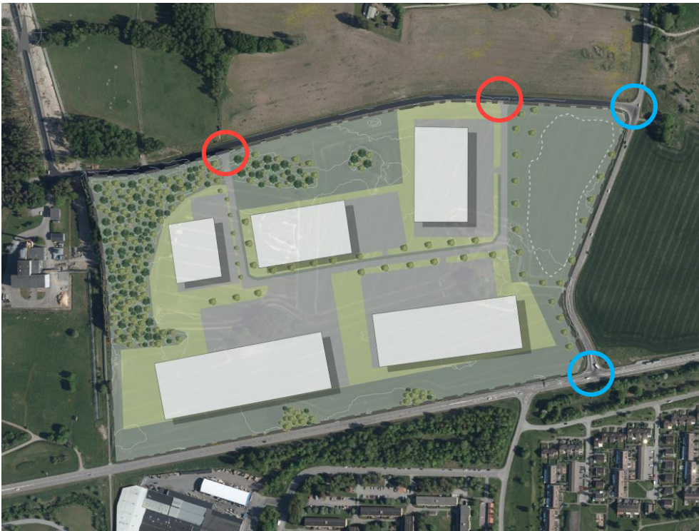
Figur 9. Korsningar som nätutläggningen tar hänsyn till i tabell 5. Röda markeringar avser anslutningar mellan ny lokalgata och Värmevägen. Blå markeringar är befintliga korsningar. Källa: Götene kommun.
