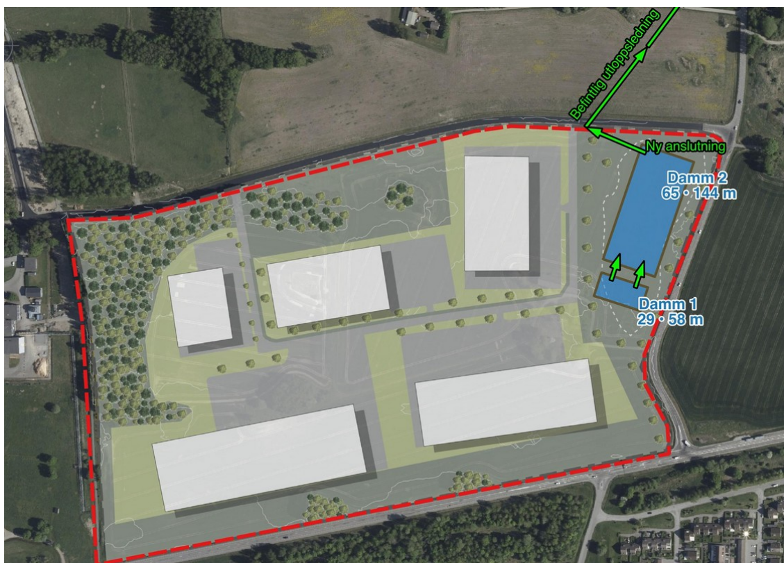
Figur 8: illustration av dimensionerade dammar inklusive slänter i förhållande till skiss av tänkbar exploatering. Dammarnas utformning och placering kan anpassas.
