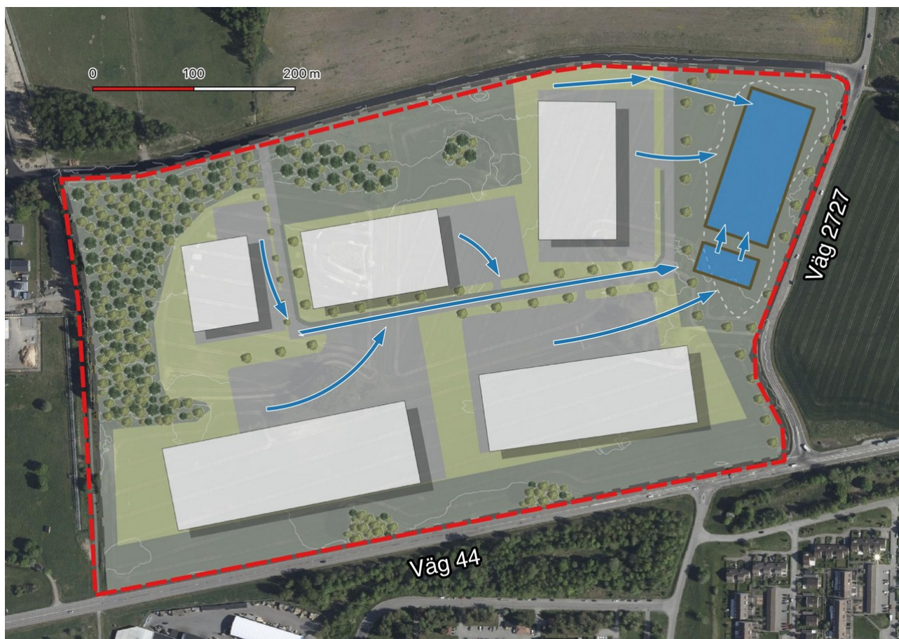
Figur 9: schematisk illustration av yttlig avrinning (blå pilar) vid skyfallsliknande regn
