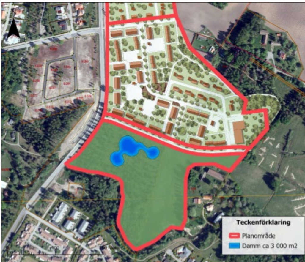
Figur 33. Förslag på placering och utformning av våt damm
