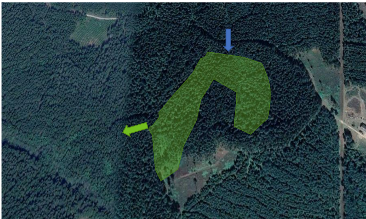
Figur 42. Läge 82. Översikt av möjligt läge med in- respektive utlopp. Denna utformning är cirka 4 hektar stor. Vilka områden som blir påverkade av denna dämningshöjd kräver vidare utredning.
