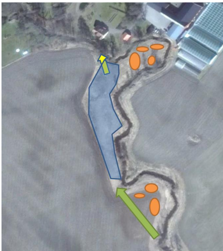
Figur 20. Läge 38. Översikt av möjligt läge med in- respektive utlopp. Grön pil är inlopp från Mariedalsån och. Inlopp från dräneringar är inte markerade. Orange markeringar visar område för mångfaldsvatten.
