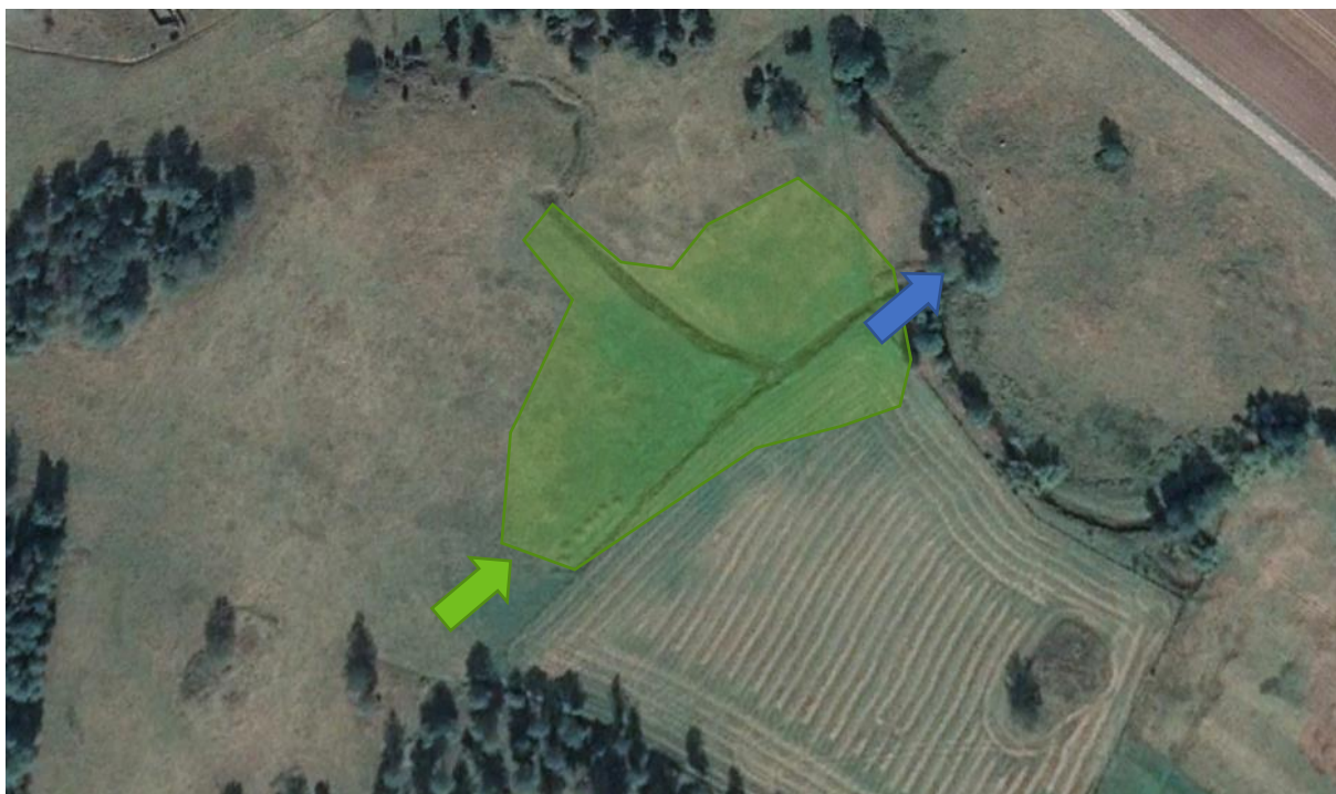
Figur 14. Läge 31. Översikt av möjligt läge med in- respektive utlopp. Inmätning krävs för att avgöra anläggningssätt och storlek på våtmarken. Först då kan även en massbalans upprättas för att vet hur mycket intilliggande åkermark kan höjas.
