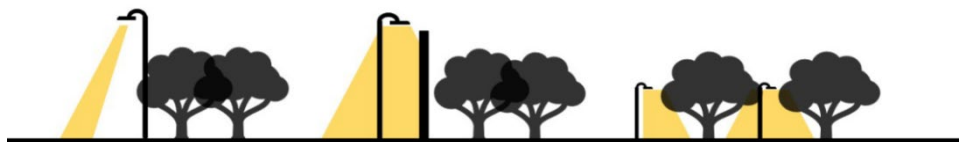
Figur 10. Lampor som kan riktas och bara lysa upp det som är avsett (exempelvis vägbanan) minskar mängden onödigt ljus. Samma effekt kan uppnås genom avskärmning eller genom att låta lampor placeras på lägre höjd.
