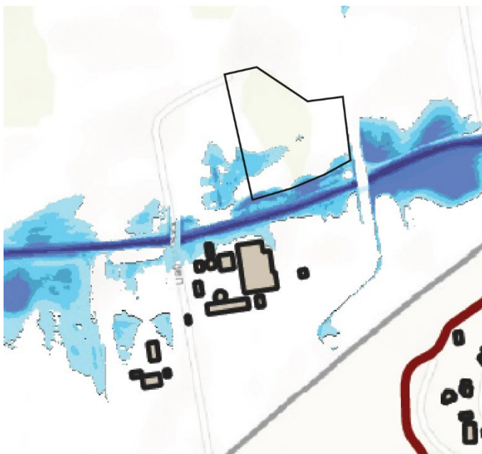
Figur 14, Utsnitt ur vattendragsmodelleringen, 200-årsflöde med P100 klimatfaktor.
