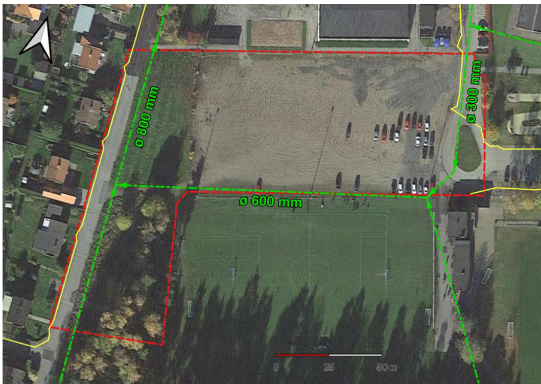
Figur 4: befintliga dagvattenledningar i området som gröna linjer (inhämtat från Götene kommun) samt elledningar (via Ledningskollen) i gult. (Ortofoto: Google)
