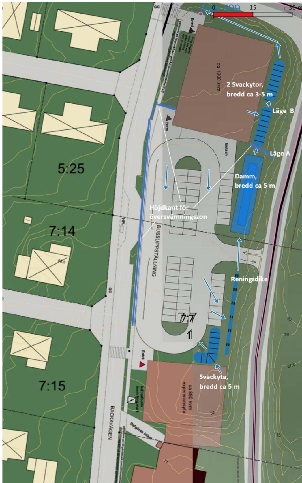
Föreslagen disposition av markytor för dagvattenhantering - illustration ur förstudie (Fig. 4 dagvattenutredning, Melica)
