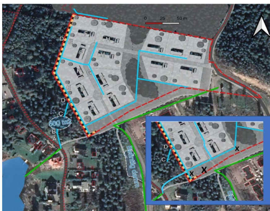
Figur 18. Figur som redovisar en översikt över föreslagen dagvattenlösning med ett västlig magasinläge. Inklippt i figuren, inom blå ram är alternativa lägen för ett motsvarande stort magasin (i läge X) eller för två mindre på två platser (x).
