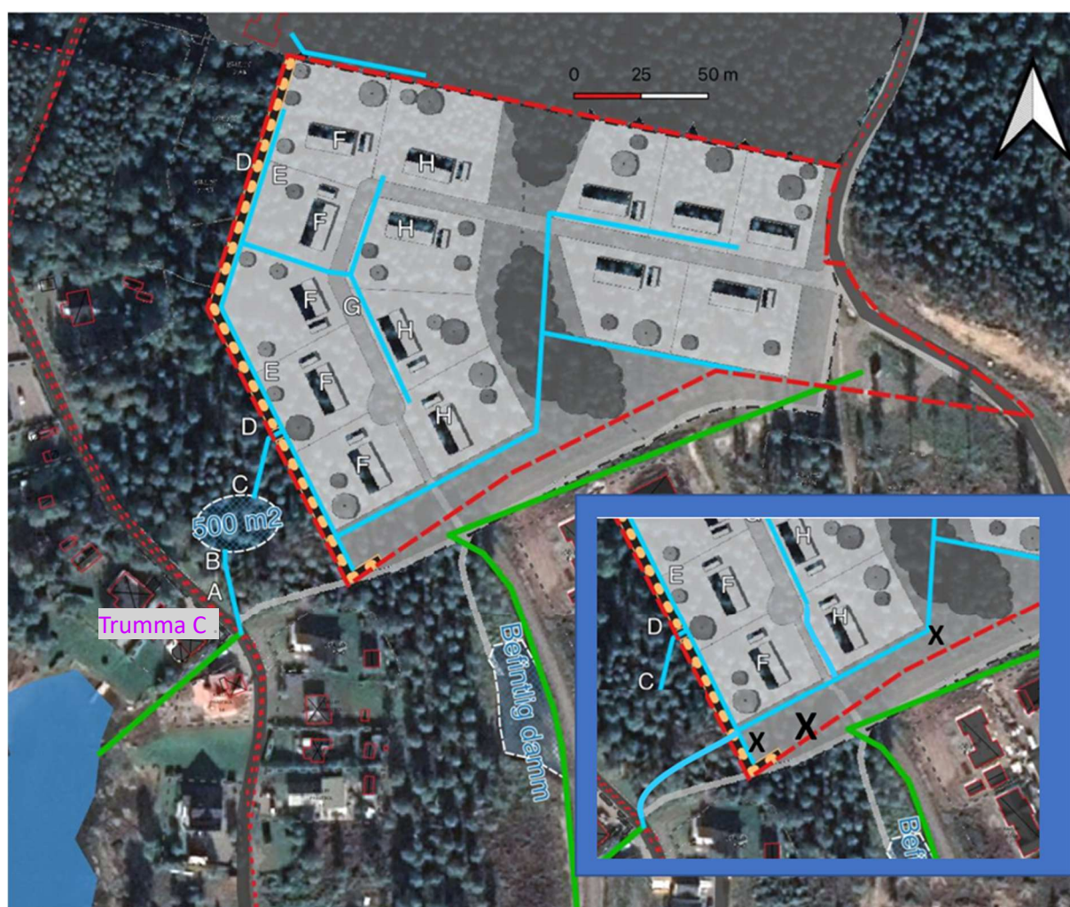
Figur 9: översikt över föreslagen dagvattenlösning med ett västlig magasinläge och med beteckningar för höjdnivåer (A – H) som ansluter till tabell 3. Inklippt i figuren, inom blå ram är alternativa lägen för ett motsvarande stort magasin (i läge X) eller för två mindre på två platser (x).
