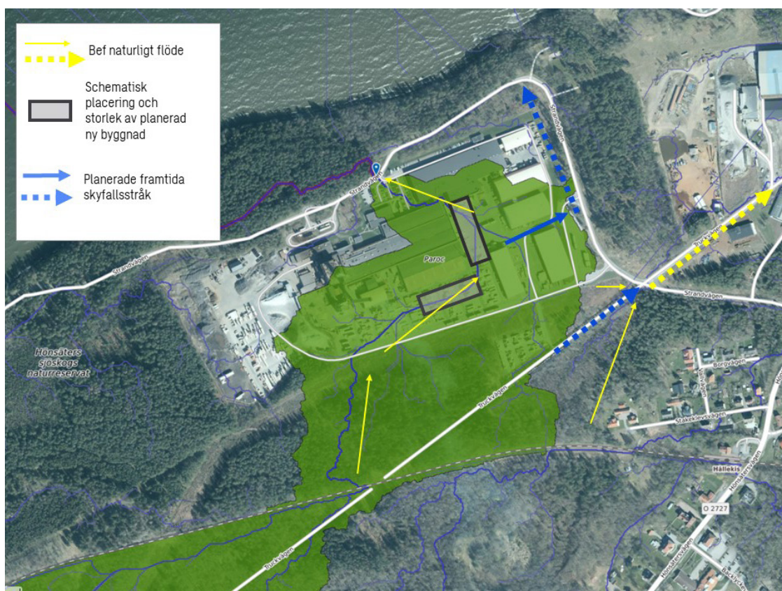
Figur 45. Befintliga och framtida ytliga rinnvägar. Befintliga rinnvägar visas med gula pilar. Gul streckad pil visar befintligt skyfallsstråk från korsningen Truckvägen-Strandvägen. Blå pil visar planerat stråk som anpassas till planerad bebyggelse och blå streckad pil visar föreslaget skyfallsstråk som planläggs.
